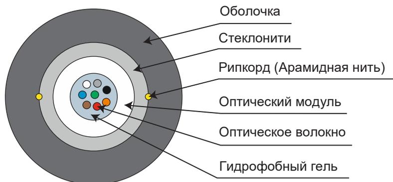
Кабель содержит оптический модуль со свободно расположенными волокнами. Свободное пространство в оптическом модуле заполнено гидрофобным гелем. Поверх модуля спирально накладываются укрепляющие стеклонити с водоблокирующим эффектом и оболочка из полиэтилена средней плотности. Под оболочкой кабеля продольно прокладываются два рипкорда.
