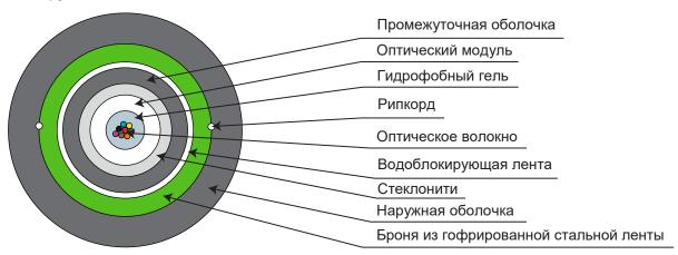
Кабель содержит оптический модуль со свободно уложенными волокнами. Свободное пространство в оптическом модуле заполнено гидрофобным гелем. Поверх модуля накладываются стеклонити с водоблокирующим эффектом, промежуточная оболочка из полиэтилена средней плотности. На промежуточную оболочку продольно накладывается водоблокирующая лента и броня из гофрированной стальной ленты. На броню накладывается оболочка из полиэтилена средней плотности. Под оболочкой кабеля расположены два рипкорда.
